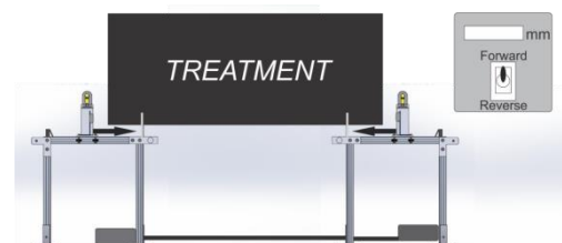
Gambar 11. Ilustrasi Cara Kerja Sistem Kontrol Motor DC pada Saat Posisi Forward .
